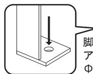
脚の接地面にアンカー固定用のΦ12mmの穴が開いています。
